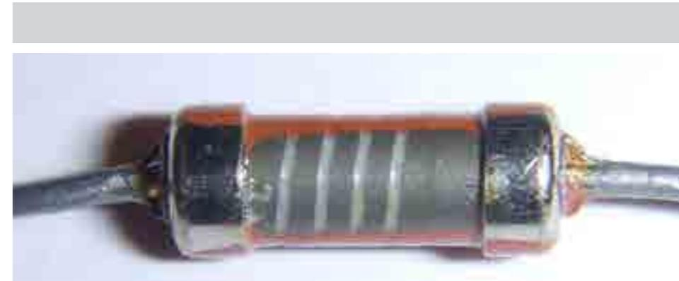
En los resistores de cuatro bandas, las dos primeras bandas nos indican siempre el valor numérico del resistor.
