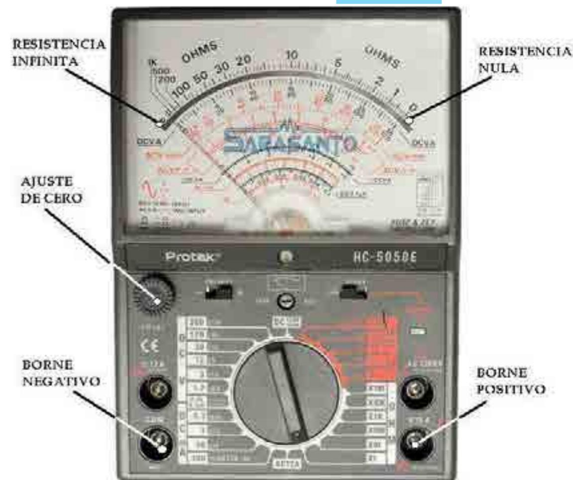
Figura 66. Multímetro Analógico.
